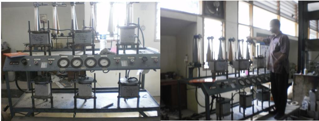
**Gambar 1. Alat Uji Permeabilitas**
