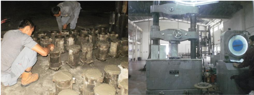
Gambar 2 Sampel dan Alat Uji Kuat Tekan Beton
