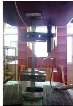
**Gambar 2. Pemasangan Spesimen Uji Tarik dan Transducer Pada UTM**
