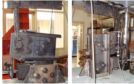
**Gambar 20. Pengujian Sambungan 3 Baut Diagonal dengan Beban Eksentris**
