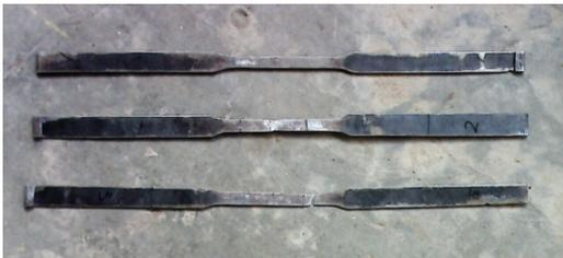
**Gambar 1. Bentuk Awal dan Kehancuran dari Spesimen Uji Tarik**
