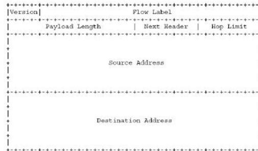
Gambar 3. Format Header IPv6
