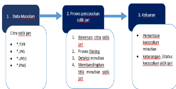
Gambar 3. Proses pencocokan minutiae
