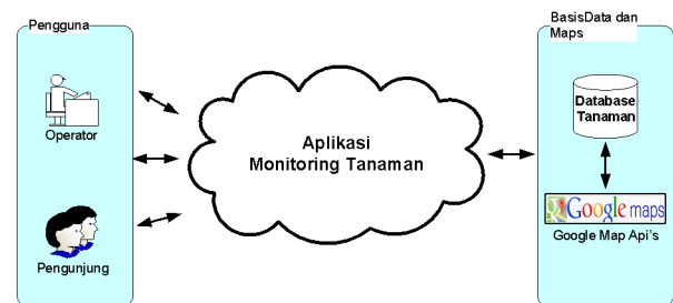
Gambar 7. Arsitektur Sistem Aplikasi Monitoring Tanaman
