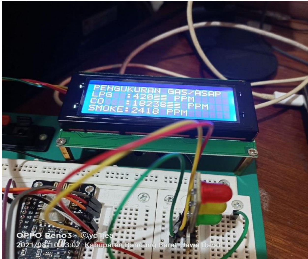
Gambar 8. Pengukuran Sensor Pada Saat Ruang Normal
