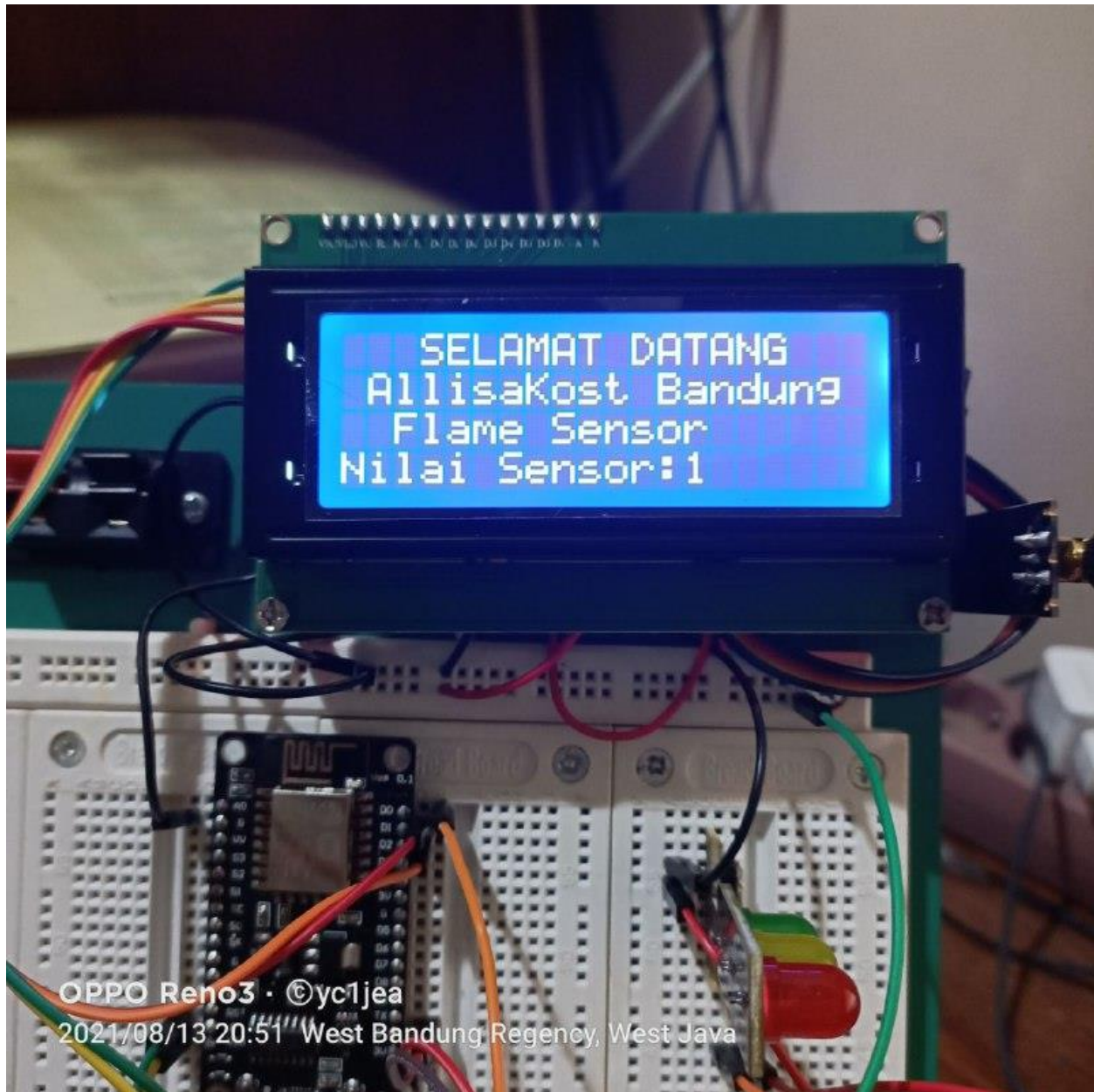
Gambar 13. Jika Terdekteksi Panas API, Nilai Sensor adalah 1 atau HIGH
