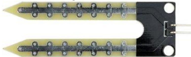
Gambar 2. Bagian Penguji yang ditancapkan ke Tanah
