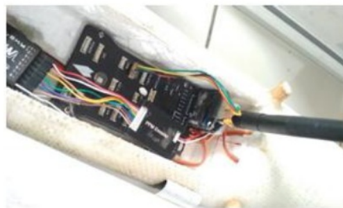
Gambar 12 Pemasangan radio Komunikasi
