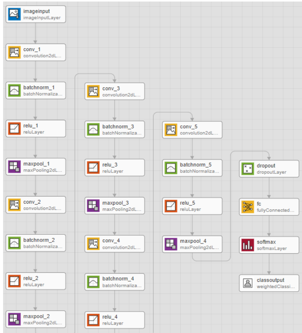
Gambar 4 Diagram Blok Arsitektur CNN
