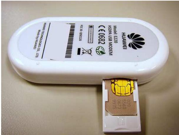
Modem GSM hampir sama dengan modem CDMA, tetapi menggunakan jalur komunikasi global system for mobile communication (GSM). Seperti halnya modem CDMA, modem GSM juga ada yang berupa flash disk, PCMCIA atau ponsel yang memiliki fitur sebagai modem.
