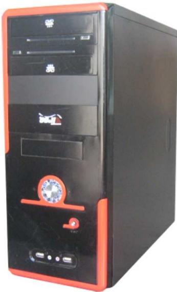
Casing merupakan alat yang berguna untuk melindungi komponen-komponen hardware dalam CPU agar aman dari gangguan luar yang dapat merusak komponen-komponen tersebut, seperti debu dan air.
