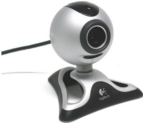
Webcam (web camera) adalah sebuah kamera video digital kecil yang dihubungkan ke computer melalui port USB.
