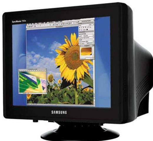
Monitor CRT (cathode ray tube / tabung sinar katoda) adalah monitor yang terbuat dari tabung hampa, sama halnya dengan monitor televisi. Hal ini yang membuat monitor CRT
