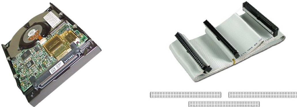
Small computer system interface (SCSI) adalah perangkat standar ANSI untuk menghubungkan device ke system computer. Umumnya SCSI merupakan teknologi parallel, tetapi banyak variant SCSI serial yang sudah beredar dipasaran, seperti FireWire dan Fibre Channel.
