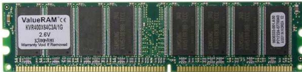
Ciri-ciri DDR sama dengan SDRAM, tetapi kecepatannya dalam memindahkan data (data transfer) mendekati kecepatan system clock. DDR memiliki 184 pin dan tersedia dalam tiga pilihan kecepatan, yaitu 266 MHz, 333 MHz dan 400 MHz.
