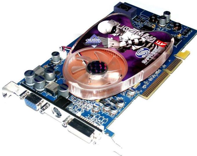
VGA AGP merupakan salah satu tipe VGA yang memiliki slot khusus pada mainboard. Biasanya slot AGP berwarna coklat, sehingga VGA card yang kita miliki harus dipasang pada slot itu. Tipe AGP juga harus disesuaikan dengan tipe VGA card yang digunakan (2x, 4x atau 8x). Pemasangan VGA card pada slotnya harus dilakukan dengan benar, karena kesalahan dalam hal ini dapat mengakibatkan terbakarnya mainboard.
