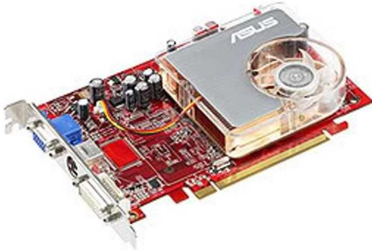
PCI Express atau dikenal juga sebagai PCIe adalah perangkat yang diluncurkan Intel. PCI Express didisain untuk menggantikan peran bus PCI local, bus PCI-X high end dan interface VGA card AGP. Tidak seperti interface PC yang lain, PCIe tersusun dalam point to point link serial yang disebut lanes.
