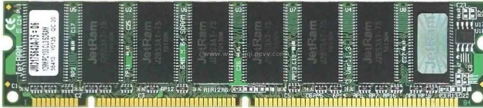
SDRAM memiliki 168 pin, SDRAM merupakan pengatur (synchronizes) memori atau CPU clock yang berfungsi untuk melakukan pemindahan data yang lebih cepat. SDRAM tersedia dalam 2 kemasan dengan 2 kecepatan yang berbeda, yaitu 100 MHz (PC-100) dan 133 MHz (PC-133).
