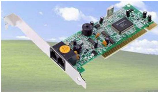
Modem dial-up atau yang biasa disebut dengan hubungan langsung adalah modem yang digunakan sebagai media koneksi internet menggunakan kabel telepon. Koneksi jenis ini menggunakan modem internal (dipasang langsung pada mainboard).
