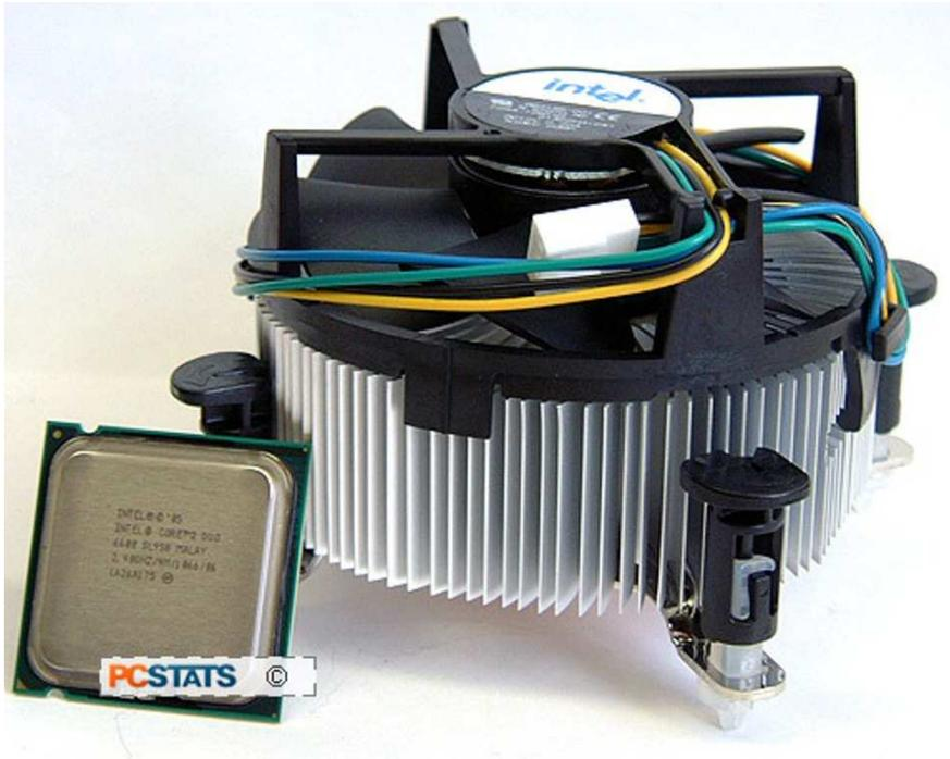
Heat sink dan kipas prosesor merupakan perangkat yang berperan penting dalam menjaga suhu prosesor. Suhu merupakan factor yang sangat mempengaruhi kerja computer secara keseluruhan. Perangkat computer dapat mengalami penurunan kinerja hingga mengalami kerusakan jika dipaksa bekerja pada suhu yang tinggi.
