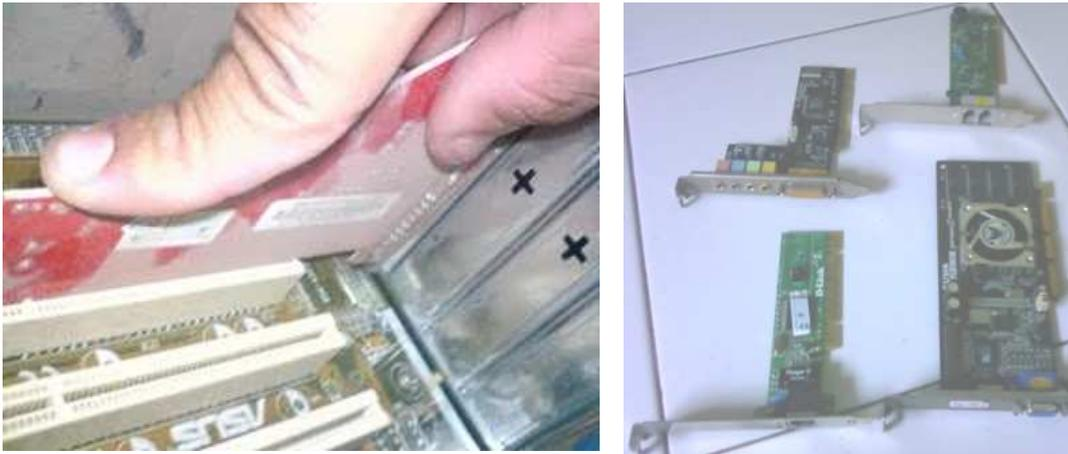
1. Pemasangan peralatan tambahan atau card add on pada mainboard sama dengan pemasangan VGA Card pada mainboard, cukup menyesuaikan slot yang digunakan oleh card add on tersebut.
