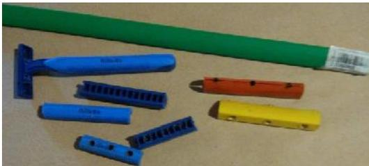
Potongan gagang cukuran Blue Gillette II spt di foto satu sisi sudah ada lubang-lubangnya, sehingga tinggal “diterusin sampai nyoblos” ke sisi lain (dg bor atau ujung solder panas) untuk dimanfaatkan sebagai spacer (2 lubang kalau utk open wire, atau 3 lubang utk 3 - wire Linear Loaded segment).
