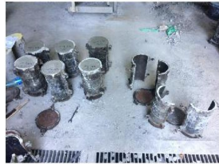
Gambar 2. Pencetakan Silinder Benda Uji Beton
