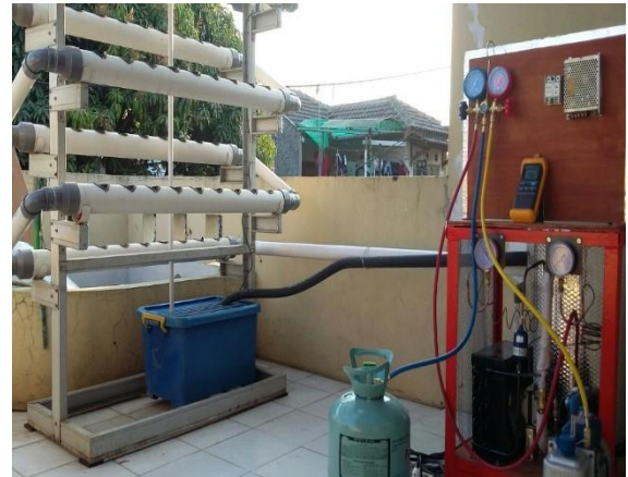
Gambar 10. Integrasi sistem refrigerasi & kit hidroponik
