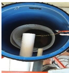
Gambar 9. Konstruksi dan peletakan evaporator
