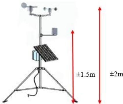
**Gambar 3.** Standarisasi Penempatan Sensor Angin dan Curah Hujan
