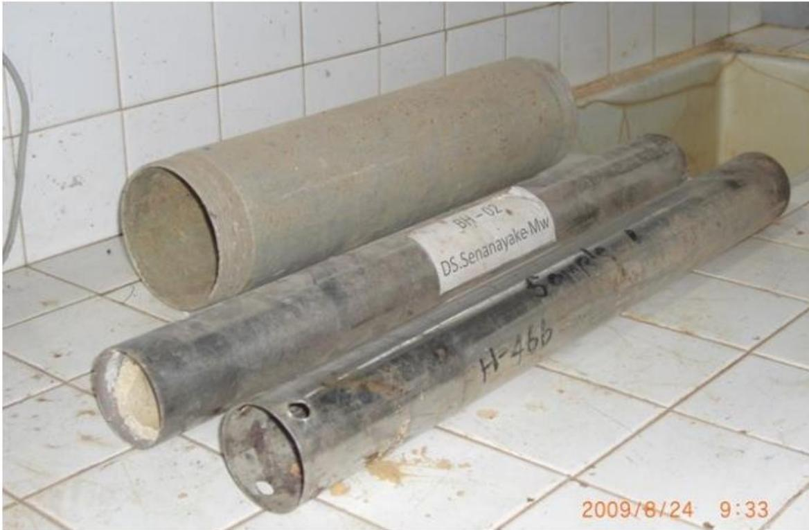
Sampel dalam kondisi tidak terganggu (Undisturb) di siapkan dalam *Shelby tube*. *Shelby tube* seharusnya diletakkan dalam posisi vertical saat penyimpanan
