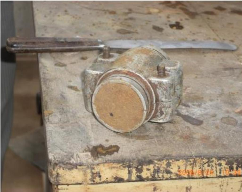
Sampel dicetak dengan tabung silinder untuk pengujian triaxial
