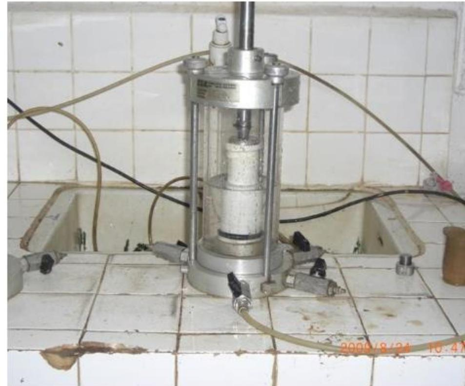
Chamber alat triaxial diisi dengan air
