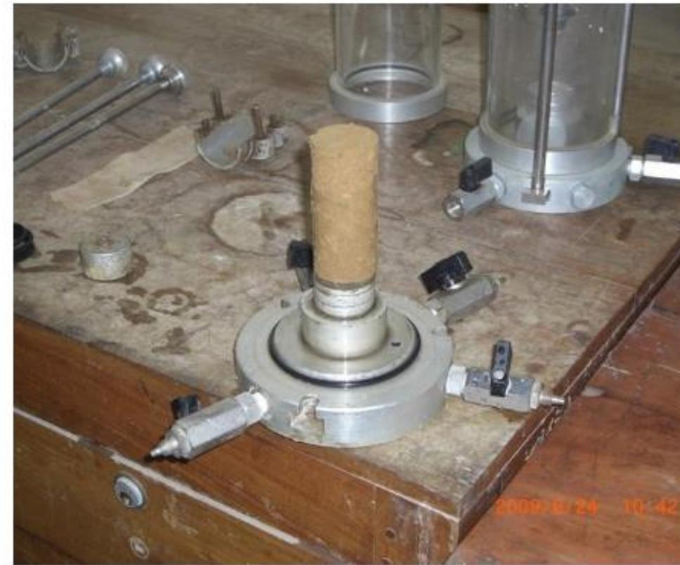
Spesimen diletakkan di atas Bottomcap alat triaxial
