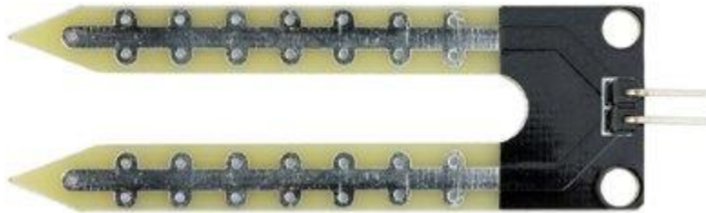
Gambar 1. Bagian Penguji yang ditancapkan ke Tanah
